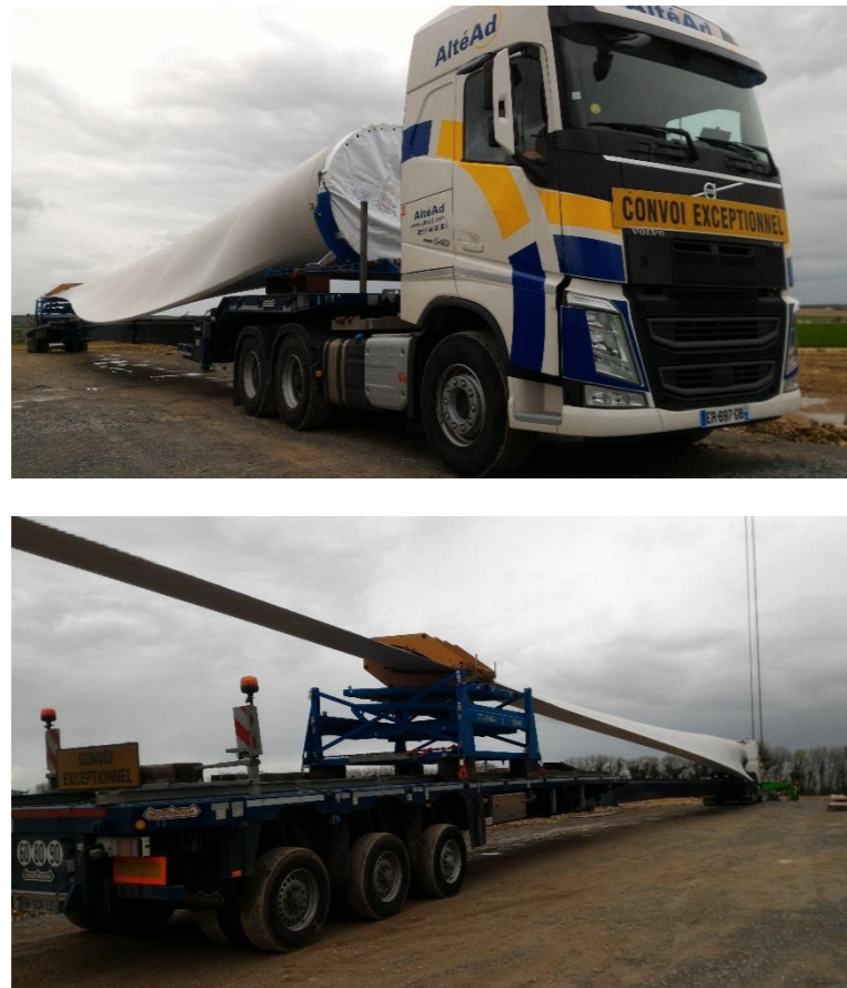
Figure 68 : Transport des pales (Source : VOLKSWIND)
